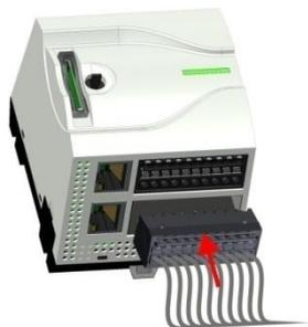
8. ➤ Подключите обратно к устройству смонтированные клеммные соединители.
