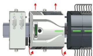
3. ➤ Снимите модуль ЦПУ с рейки, поворачивая его снизу вверх относительно рейки.
