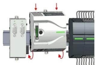
5. ➤ Вытяните у нового ЦПУ тяги фиксаторов наружу на один щелчок. Наденьте модуль ЦПУ его верхней частью на монтажную рейку и поверните его сверху вниз до упора.
