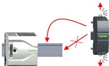
4. ➔ Вытяните тяги фиксаторов у нового модуля расширения на один щелчок.
