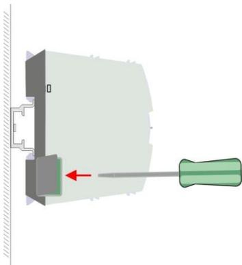
2. → Коммуникационный модуль на тыльной стороне имеет два фиксатора – верхний и нижний. Вытяните тяги фиксаторов наружу на один щелчок, как показано на рисунке.
