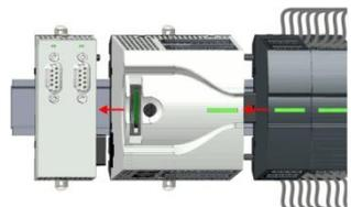
2. ➤ Сдвигая влево по монтажной рейке, отсоедините коммуникационный модуль от модуля ЦПУ, а также модуль ЦПУ от модулей расширения.
