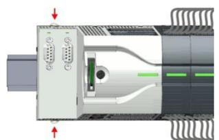
7. ➤ Наденьте коммуникационный модуль его верхней частью на монтажную рейку и поверните по направлению сверху вниз до упора.
