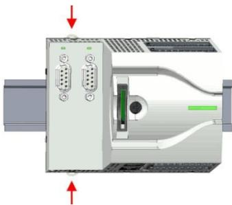
5. Закрепите коммуникационный модуль на монтажной рейке, переведя его фиксаторы в исходное (утопленное) положение.
