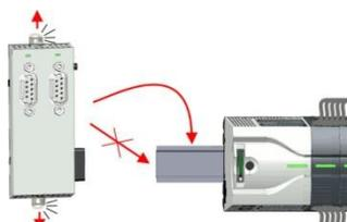
4. ➤ Отсоедините от модуля ЦПУ коммуникационный модуль, сдвигая его влево по монтажной рейке.
