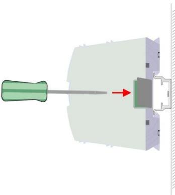
1. С помощью отвёртки удалите заглушку разъёма системной шины модуля ЦПУ, расположенную на его правой боковой поверхности.
