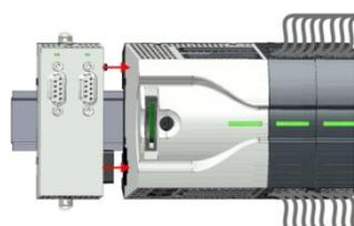
6. ➤ Вытяните тяги фиксаторов у нового коммуникационного модуля наружу на один щелчок.
