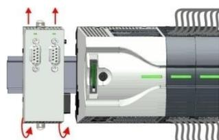
3. ➤ С помощью отвёртки вытяните тяги фиксаторов у заменяемого коммуникационного модуля наружу на один щелчок.
