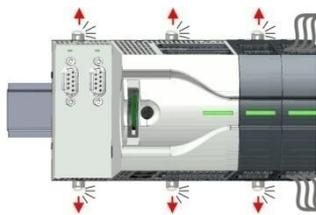
1. Рассоедините между собой все модули слева от заменяемого модуля расширения, а также и его самого от модуля справа, для чего с помощью отвёртки вытяните наружу тяги их фиксаторов...
