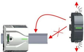
2. Каждый модуль расширения на тыльной стороне имеет два фиксатора – верхний и нижний. Вытяните тяги обоих фиксаторов наружу на один щелчок, как показано на рисунке.
