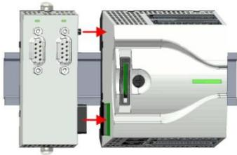
4. Подключите коммуникационный модуль к процессорному, сдвигая его вправо до момента полного сочленения разъёмов системной шины обоих модулей.
