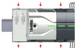
7. ➔ Задвиньте тяги фиксаторов в исходное (утопленное) положение.
