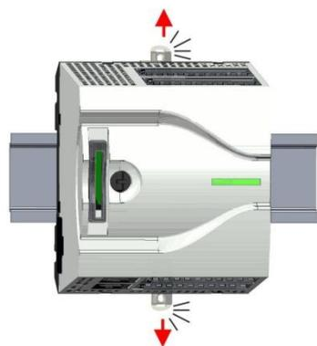
1. ➤ Используя отвёртку, вытяните у модуля ЦПУ тяги фиксаторов наружу на один щелчок.
