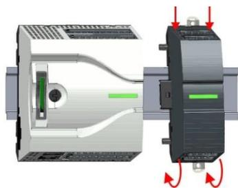
3. → Наденьте модуль расширения его верхней частью на монтажную рейку и поверните его сверху вниз до упора.
