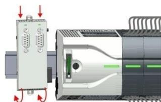
5. ➤ Снимите коммуникационный модуль с монтажной рейки, поворачивая его по направлению вверх.
