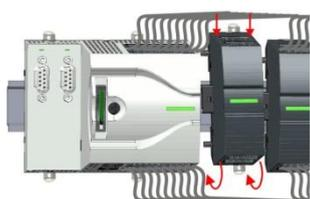
5. ➔ Наденьте модуль расширения его верхней частью на монтажную рейку и поверните его сверху вниз до упора.
