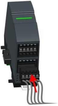
9. Подключите обратно к устройству смонтированные клеммные соединители.
