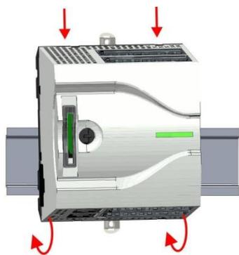
4. Наденьте модуль ЦПУ его верхней частью на монтажную рейку и поверните его сверху вниз до упора.
