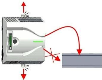
3. Вытяните у нового ЦПУ тяги фиксаторов наружу на один щелчок.
