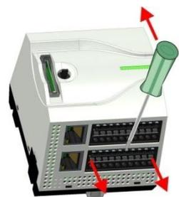
**7.** ➤ Закрепите модуль ЦПУ на монтажной рейке, переведя тяги его фиксаторов в исходное (утопленное) положение.
