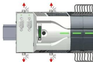
1. ➤ Если к ЦПУ подключен коммуникационный модуль, то первым делом необходимо его отсоединить. Для этого с помощью отвертки вытяните тяги фиксаторов коммуникационного модуля и модуля ЦПУ наружу на один щелчок.
