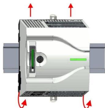
2. ➤ Снимите модуль ЦПУ с рейки, поворачивая его снизу вверх относительно рейки.
