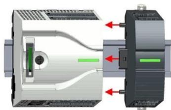
4. → Подключите модуль расширения к процессорному, сдвигая его влево до момента полного сочленения раёмов системной шины обоих модулей.
