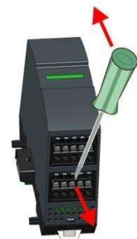
8. ➔ Извлеките из нового установленного модуля расширения его штатные клеммные соединители.
