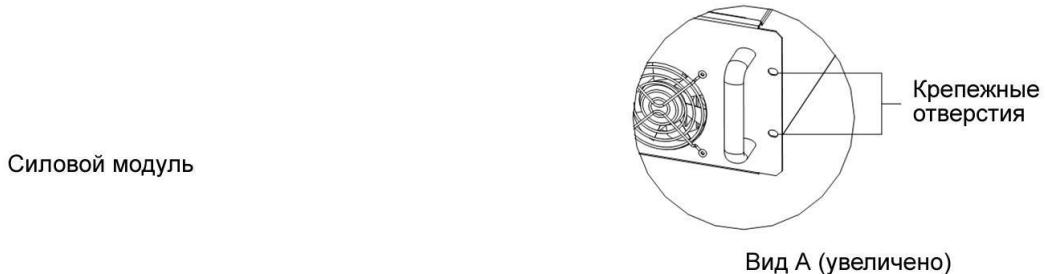
Рис. 1-8. Схема установки силового модуля
