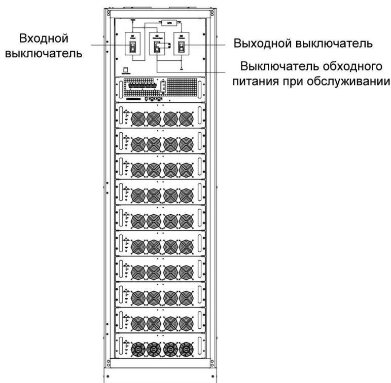
Рис. 3-1. Схема установки силового модуля
