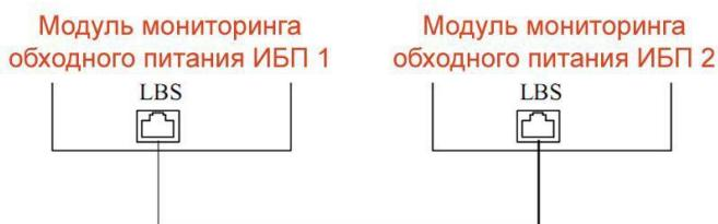
Рис. 1-20. Схема соединения LBS
