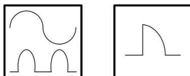
Рис. 1-10. Обозначения УЗО
