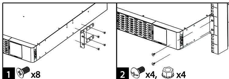
1. Прикрепите кронштейны с помощью прилагаемых винтов M5 с потайной головкой.
