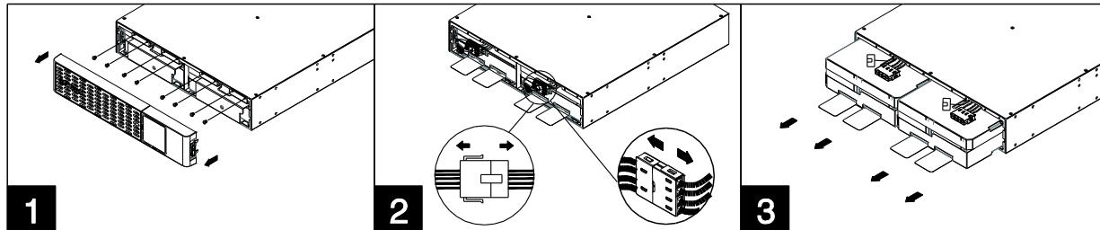
1. Отсоедините дополнительный аккумуляторный модуль от ИБП, снимите лицевую панель и открутите винты на крышке батареи, а затем снимите крышку батареи.
