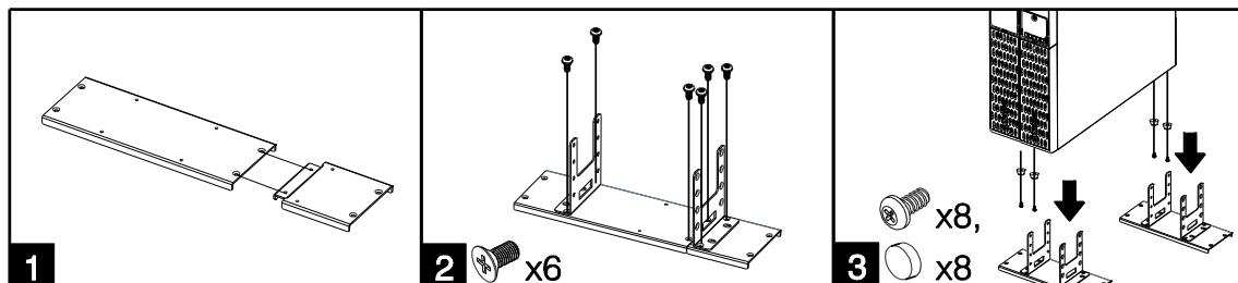
1. Присоедините расширенное основание к опорной пластине башни из комплекта аксессуаров для ИБП.
