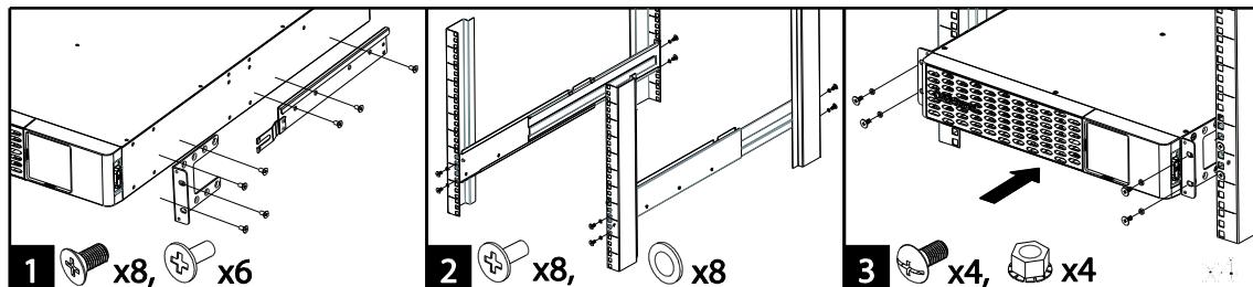
1. Для крепления кронштейнов используйте прилагаемые винты M5 с потайной головкой и прилагаемые винты M5 с плоской головкой для подвесных кронштейнов.
