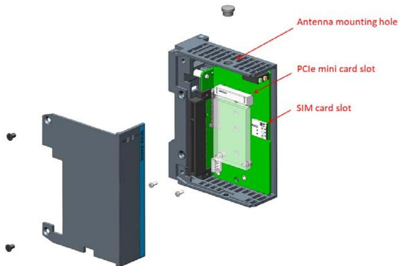
Figure 5.22 AMAX-5400E PCIe mini card installation guide
