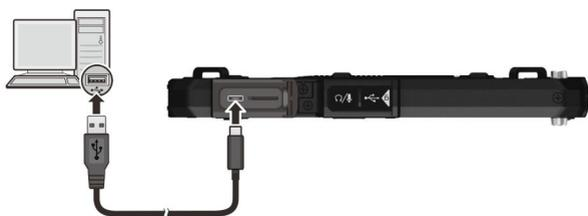
**ПРИМЕЧАНИЕ:** С помощью подходящего адаптера можно подключать периферийные USB устройства, имеющие разъем Type-A, к разъему Type-C. Однако Getac не гарантирует совместимость со всеми периферийными USB устройствами при использовании адаптера.
