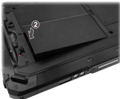
6. Передвиньте фиксатор батареи в положение «Закрыто» (🔒).
