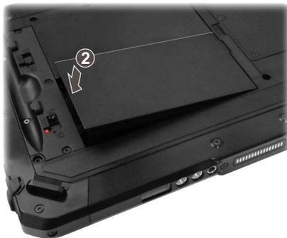
2. Передвиньте фиксатор батареи в положение «Закрыто» (🔒).
