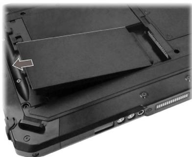
5. Соблюдая полярность аккумулятора, установите его в отсек аккумулятора под углом (❶) и нажмите на противоположную сторону крышки отсека (❷).
