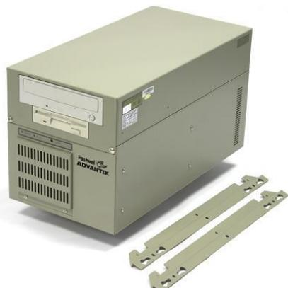
Если предприятию необходимо компактное, но в тоже время производительное и функциональное решение хороший выбор – станция технологического управления AdvantiX IPC-SYS4. Этот промышленный компьютер построен с использованием PICMG 1.3 платы. Такой дизайн системы повышает функциональность и удобство обслуживания, в конечном итоге снижая суммарную стоимость владения.
