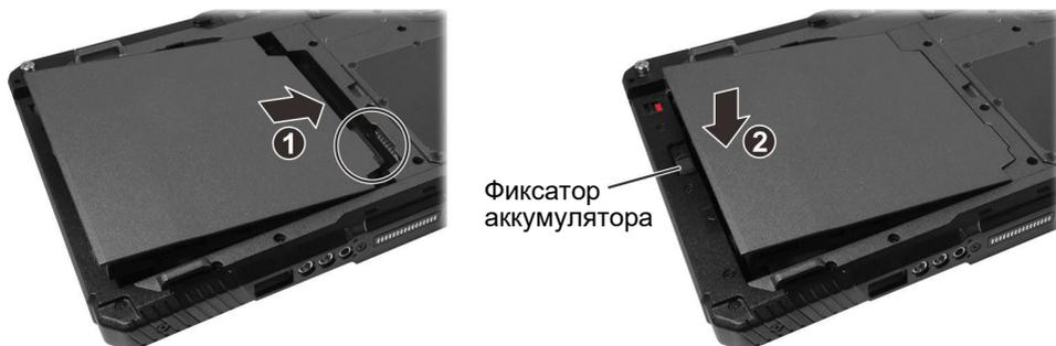
4. Сдвиньте защитный замок в положение блокировки (🔒).
