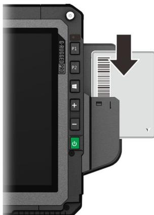
**ПРИМЕЧАНИЕ:** Обязательно плотно прижмите магнитную полосу к считывателю, когда проводите ее. Если карта прижата неплотно или провести ее неполностью, считывание не произойдет.
