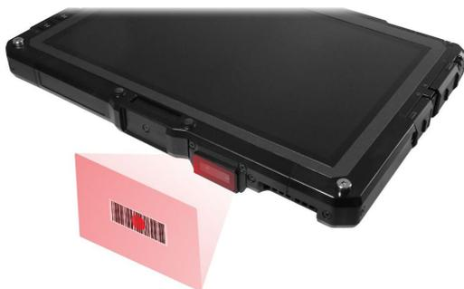
**ПРИМЕЧАНИЕ:** На результатах сканирования могут сказаться окружающее освещение или неправильный угол сканирования.
