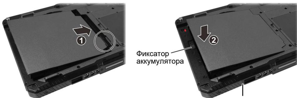
2. Сдвиньте защитный замок в положение блокировки (🔒).
