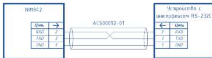
Рисунок 80 – Подключение внешнего устройства по трехпроводной схеме
