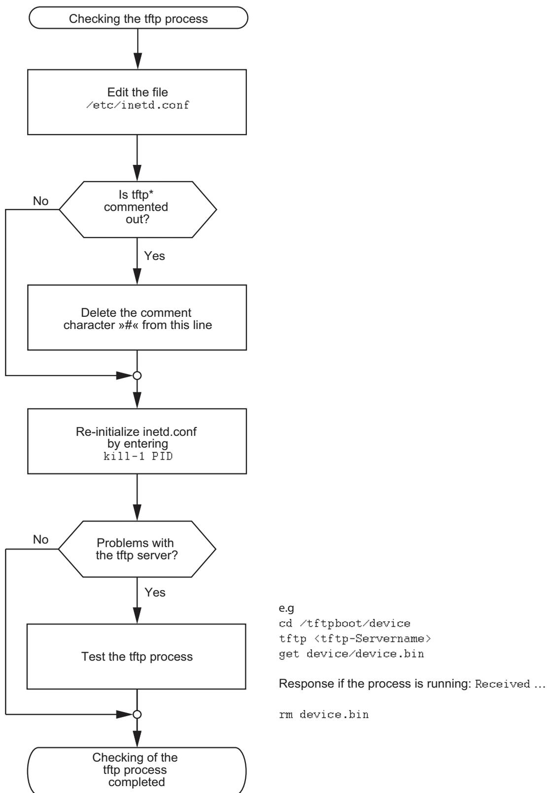
\* tftp dgram udp wait root/usr/etc/in.tftpd in.tftpd /tftpboot
