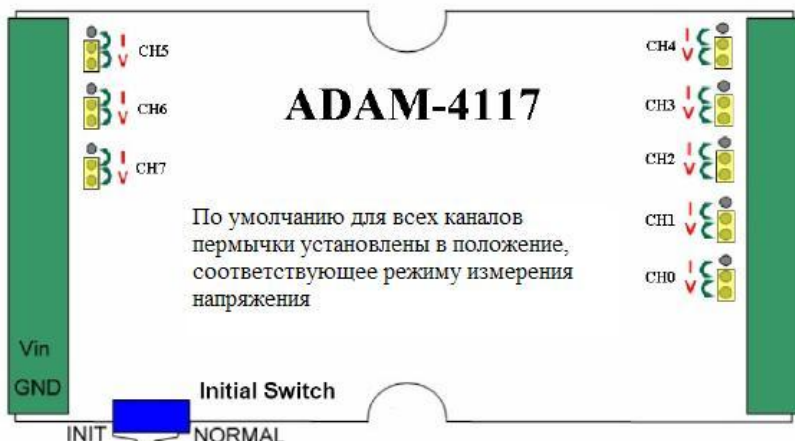
Рис. 3-2. Установка перемычек в модуле ADAM-4117
