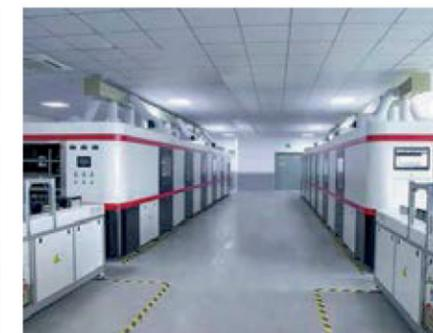
Цех по автоматическим испытаниям на долговечность
