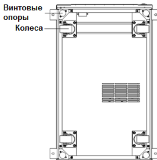
Рис.2-7 Винтовые опоры и колеса (вид снизу)
