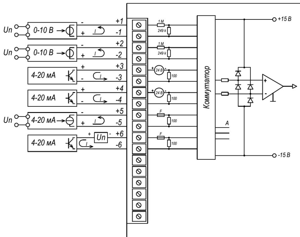
Рисунок 4.2 – Примеры схем подключения ПП различного типа
