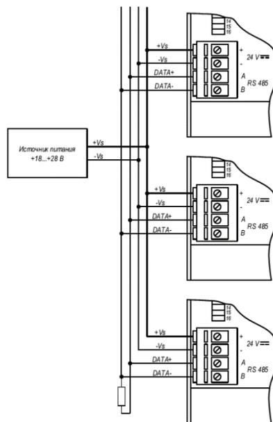
Рисунок 4.4 – Подключение модулей к информационной сети
