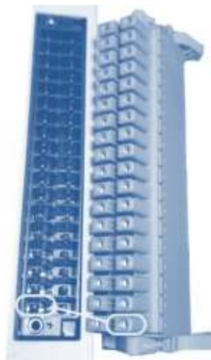
Рисунок 9 – Форма отливки пазов контактов для защиты от неправильного подключения
