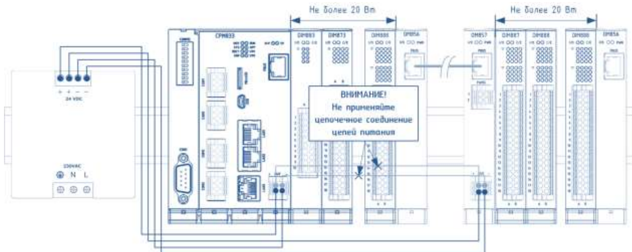
Рисунок 80 – Организация цифрового питания Fastwel I/O-2R
