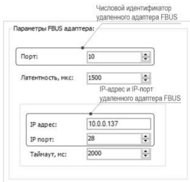
Рисунок 30 – Редактор конфигурации удаленного адаптера FBUS IDE МЭК 61131-3
