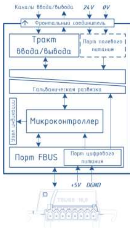
Рисунок 75 – Структурная схема периферийного модуля Fastwel I/O-2
