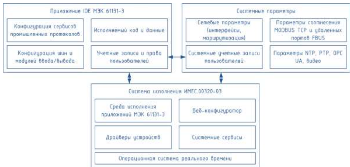
Рисунок 12 – Программная конфигурация ПЛК Fastwel I/O-2
