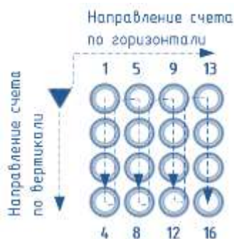
Рисунок 85 – Маркировка элементов многопозиционных групп
