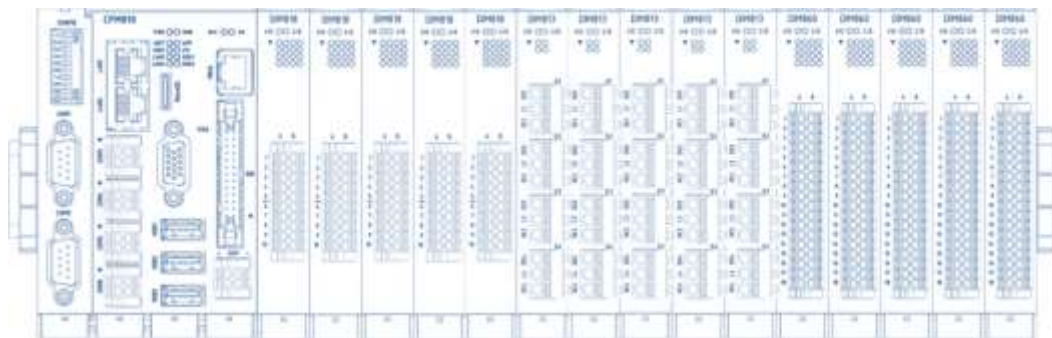
Рисунок 1 – Базовая конфигурация ПЛК с одним набором модулей Fastwel I/O-2
