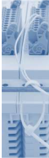
Рисунок 110 – Крепление проводов к шине комплекта ACS00098-02 пластиковой стяжкой
