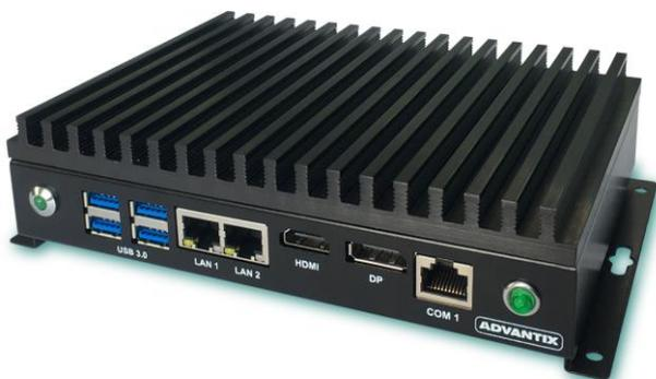
Безвентиляторный компьютер ER-4100 предназначен для работы при низких и высоких температурах. При этом оставаясь доступным по цене решением с неплохим функционалом. Доступен к заказу до 2023+ года.
