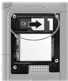
3. Закройте крышку и закрепите 4 винтами.
