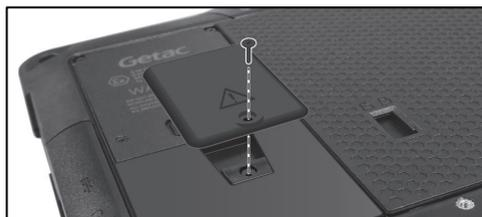
3. Закрепите небольшую прокладку на месте, затянув другой, более короткий винт из комплекта поставки T800-Ex. (Не используйте винт, извлеченный на предыдущем этапе.)
