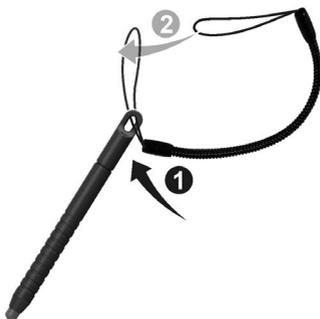
2. Пропустите другую концевую петлю сквозь отверстие для фала на компьютере (поз. **1** на рисунке ниже). Затем пропустите стилус и фал сквозь эту петлю (поз. **2** на рисунке ниже) и туго затяните петлю.
