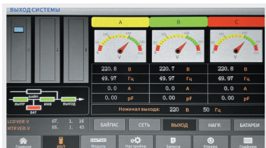
Многоуровневый контроль параметров работы, состояния ИБП и сети с регистрацией данных
