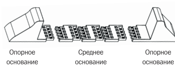
Рисунок 5-2 Установка опор с удлинителями
