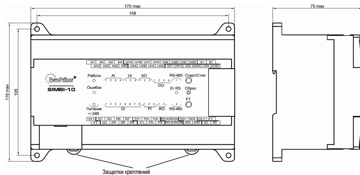
Рисунок А.1 – Габаритные и установочные размеры Simbi-10
