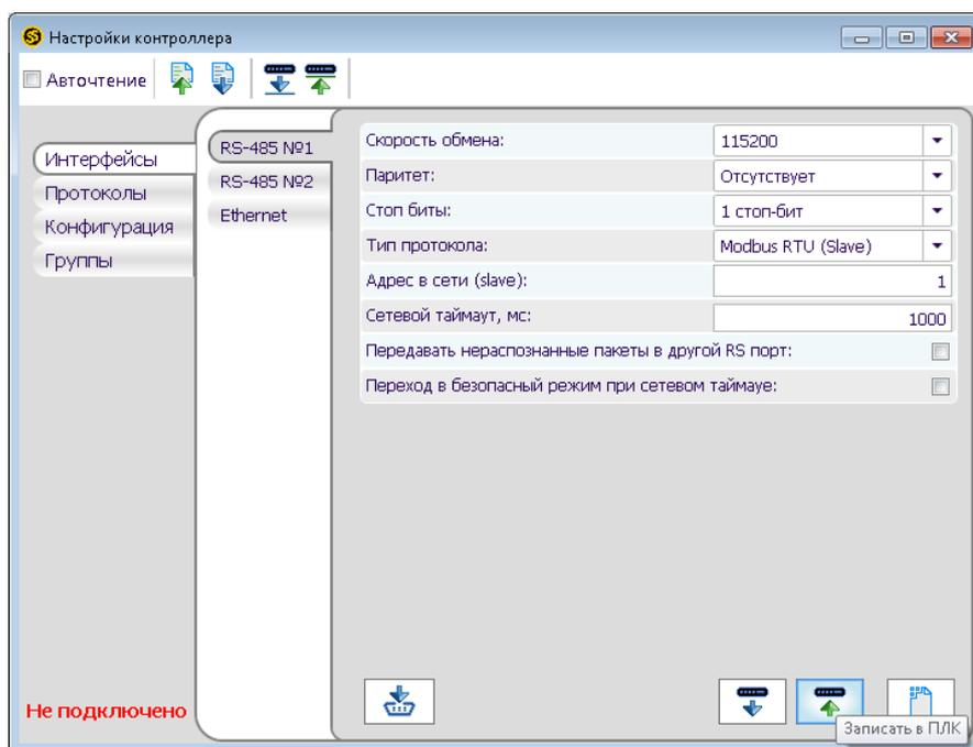
Рисунок 1.11 – Конфигурирование интерфейсов с помощью программы «SimbiSoft»
