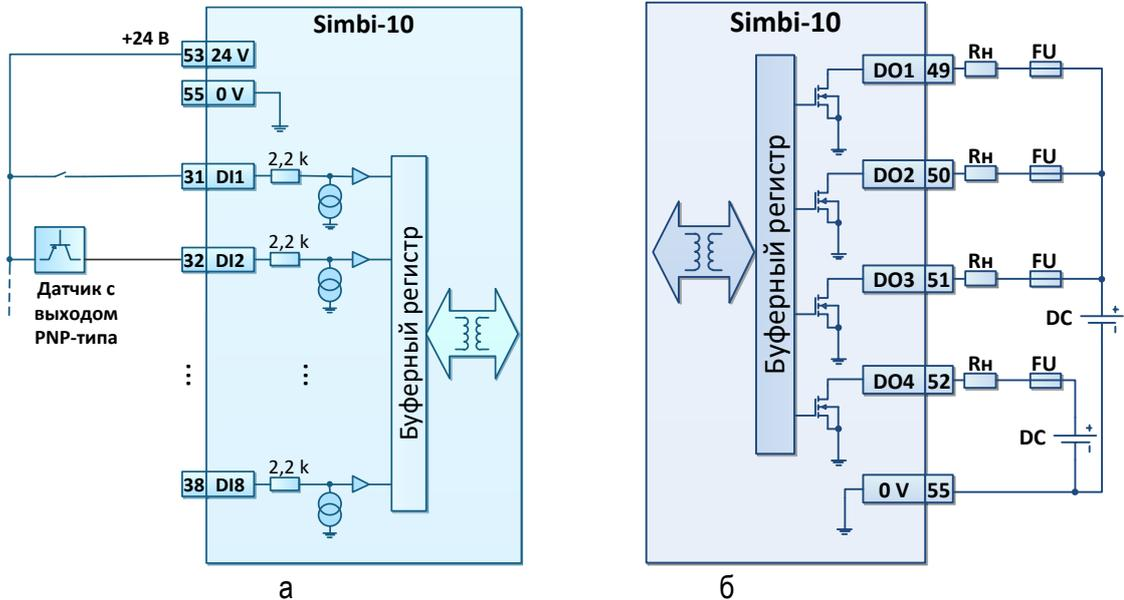
Рисунок 1.6 - а – схема подключения дискретных каналов ввода подгруппы-4
