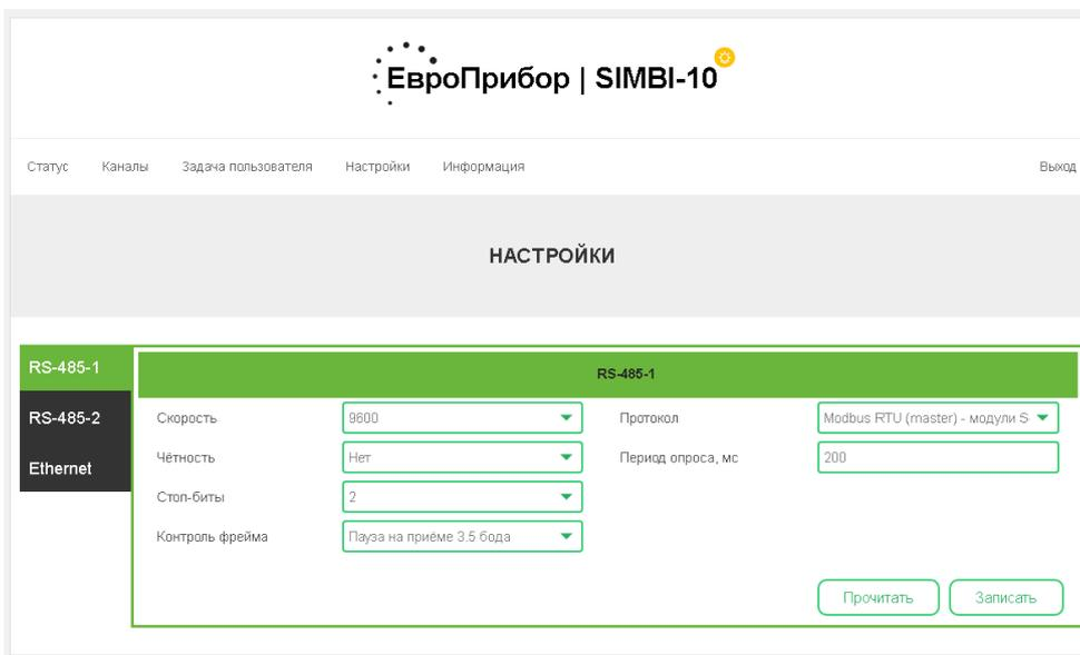
Рисунок 1.13 – Настройка интерфейсов через встроенный WEB-сервер
