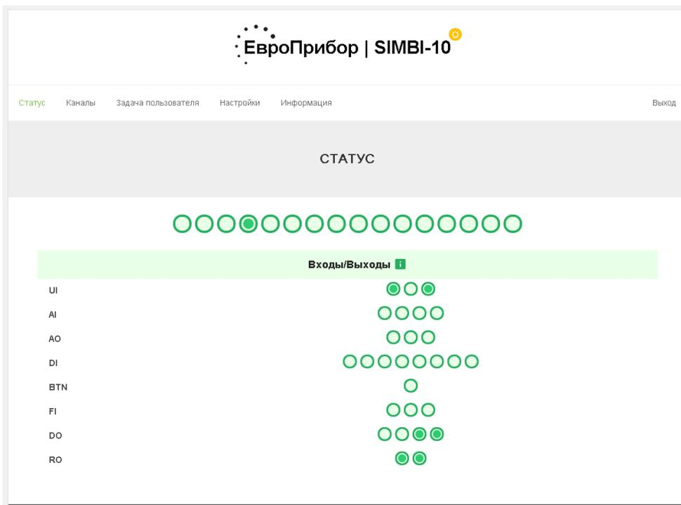
Рисунок 1.12 – Мониторинг состояния КПМ через встроенный WEB-сервер
