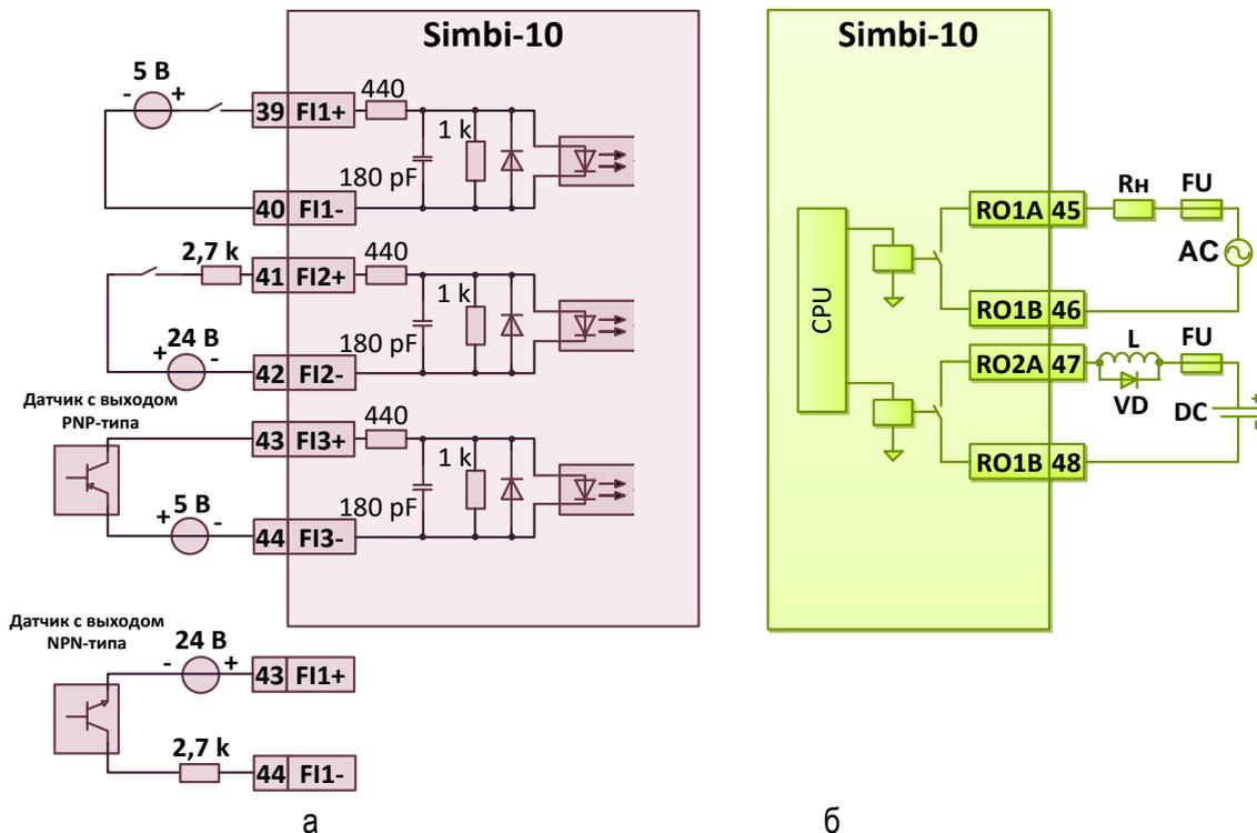
Рисунок 1.7 - а – схема подключения дискретных каналов ввода подгруппы-5
