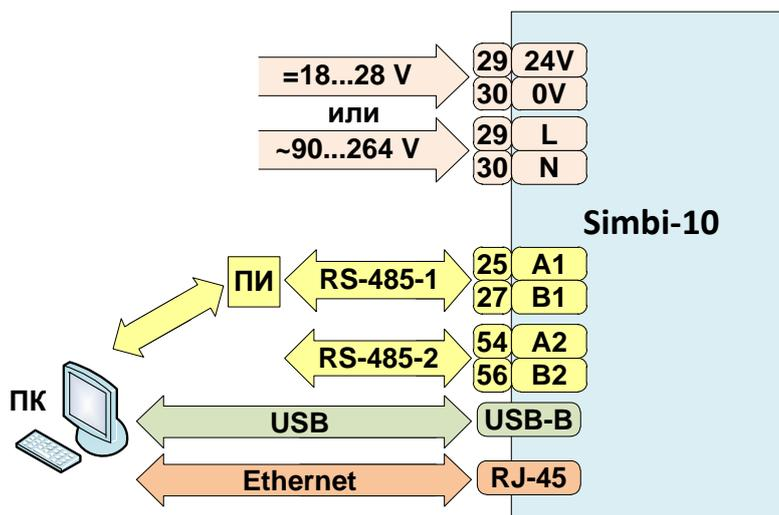
Рисунок 1.2 – Схема подключения линий питания и интерфейсов
