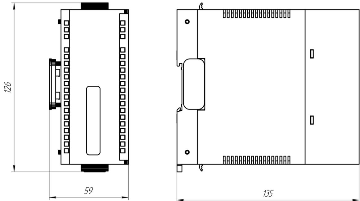
Примечание - Замок для крепления на монтажную рейку открывается с помощью нижней защелки.
