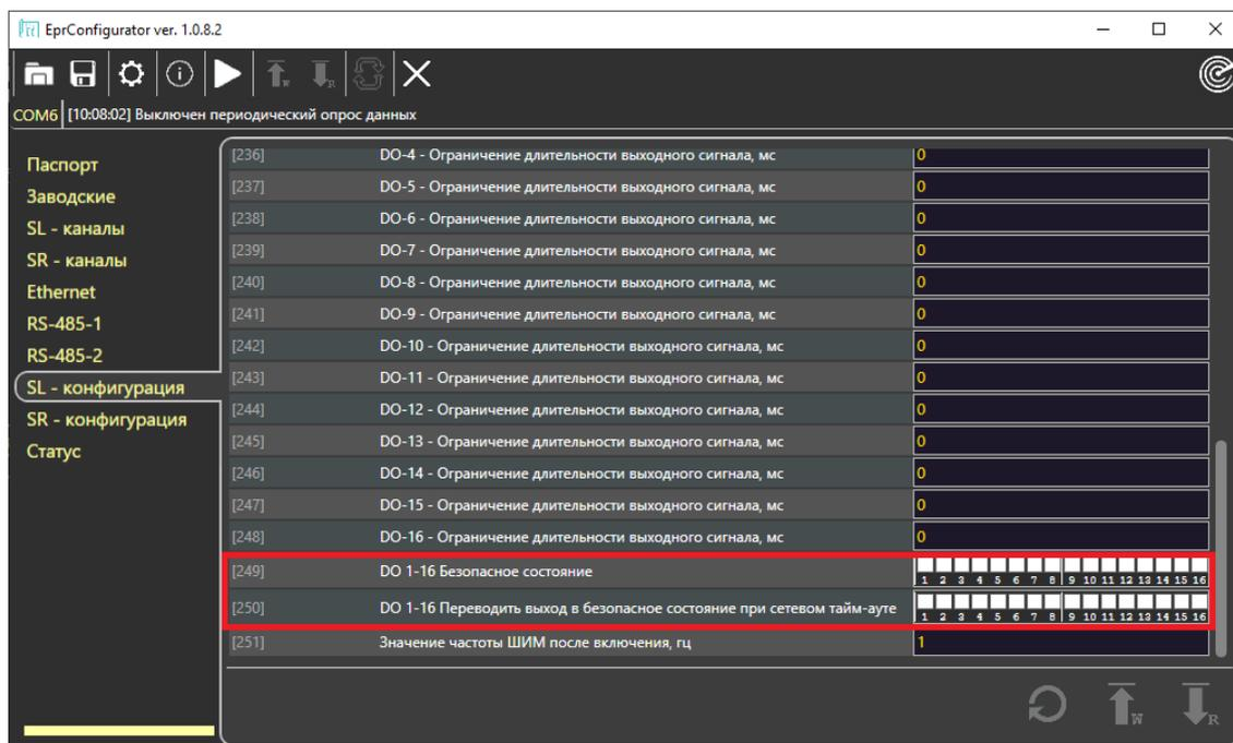
Рисунок 1.6 – Настройка безопасного состояние модуля контроллера Symbol-300 S-300-DO16, S-300-DO32 в СПО EprConfigurator
