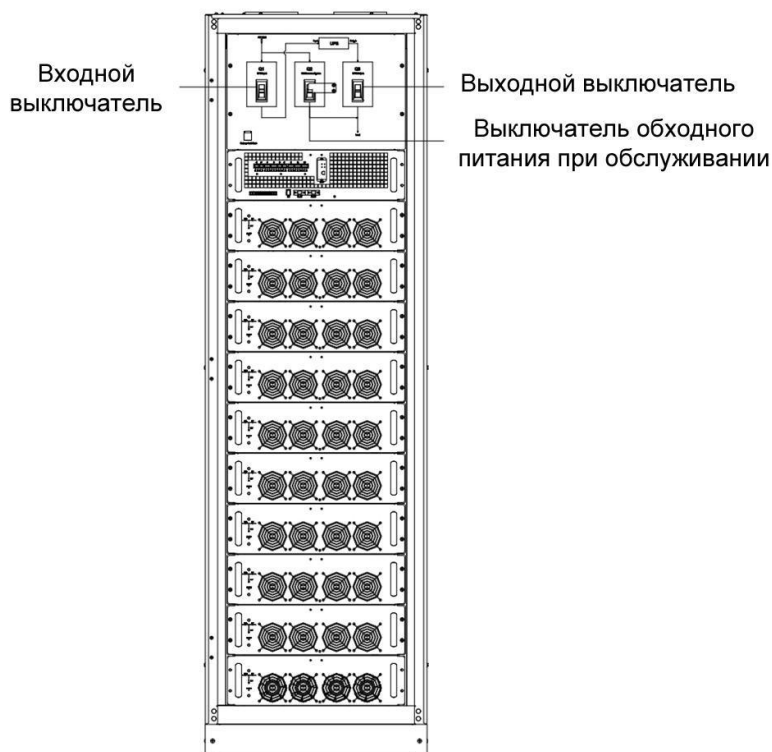
Рис. 3-1. Схема установки силового модуля
