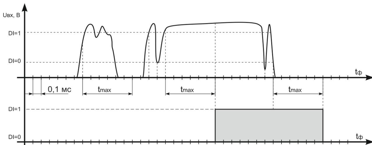
Рисунок 4.6 – Диаграмма изменения состояния входа модуля
