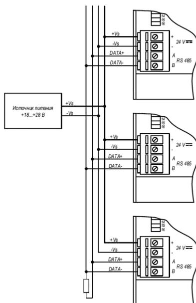
Рисунок 4.5 – Подключение модулей к информационной сети
