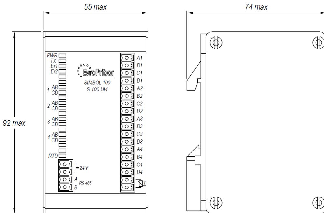
Рисунок А.1 – Габаритные размеры модуля S-100-U14
