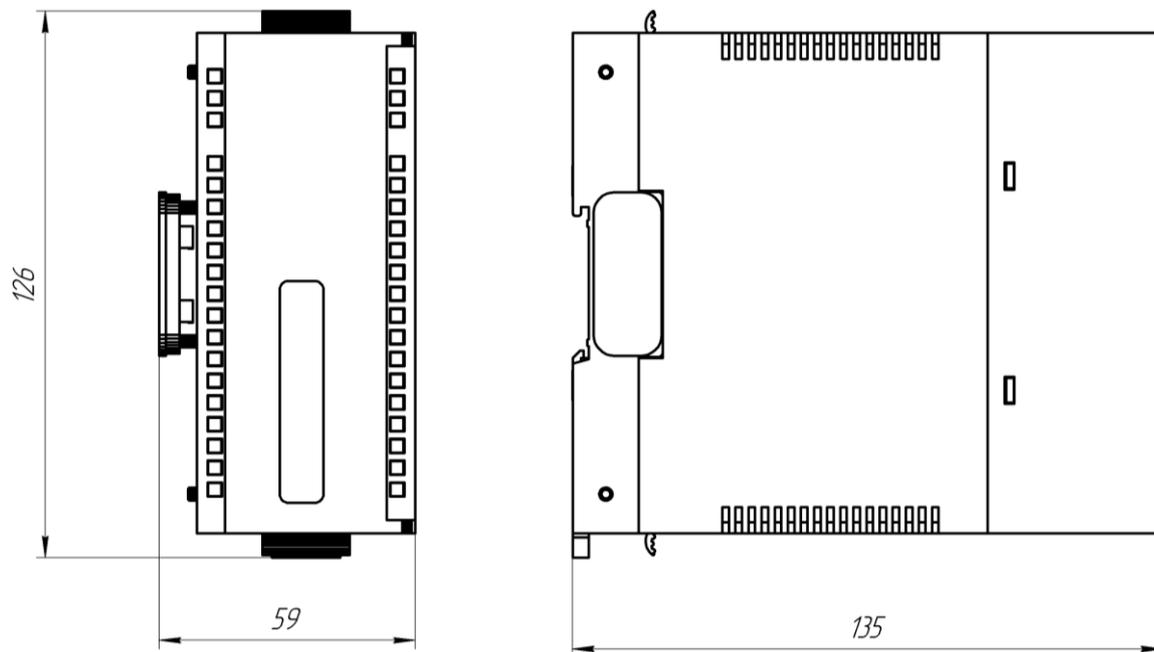
Примечание - Замок для крепления на монтажную рейку открывается с помощью нижней защелки.
