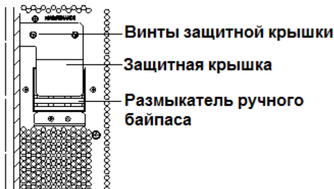
Рис.4-2 Защитная крышка ручного байпаса
